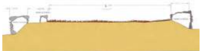
Figura 2. Corte transversal de camino encerrado por muros laterales.
